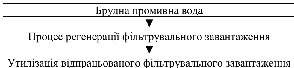
Рис. 3 – Загальна блок-схема алгоритму екологічного модуля системи оцінки досліджуваних зернистих фільтрувальних завантажень
