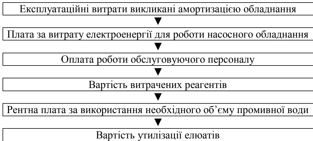
Рис. 2 – Загальна блок-схема алгоритму економічного модуля системи оцінки досліджуваних зернистих фільтрувальних завантажень
