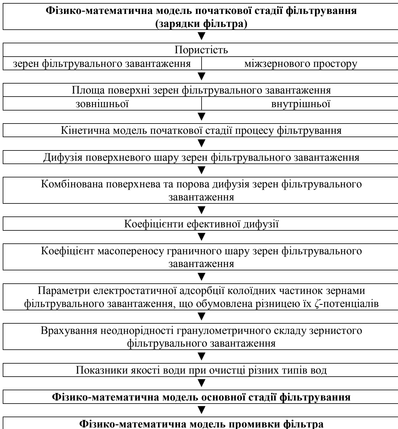
Рис. 1 – Загальна блок-схема алгоритму модуля якості очищення води системи оцінки досліджуваних зернистих фільтрувальних завантажень
